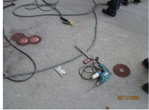
รูปที่ 3 การจัดเก็บอุปกรณ์ในการซ่อมบำรุงไม่เป็นระเบียบซึ่งอาจทำให้เกิดอันตรายต่อคนงาน ในบริเวณดังกล่าวได้
